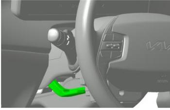
Bajar la palanca para ajustar la posición del volante y luego subir para fijar la posición.
